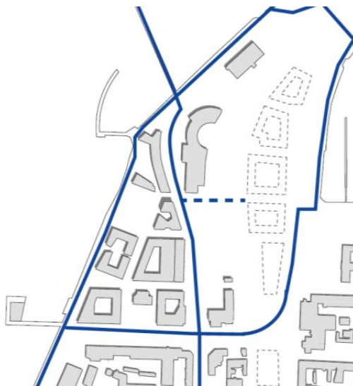
Förslaget gång- och cykelnät på Pottholmen, etapp 1. Streckad linje över järnvägen avser en gångbro.
