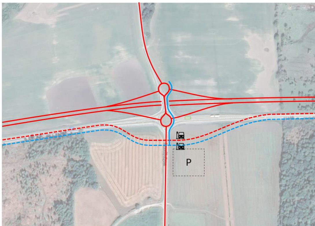
Figur 20. Alternativ med ruterlösning. E22 och ramper/droppar visas med röd heldragen linje liksom väg 672/673. Blå heldragen linje är föreslagen gång- och cykelväg som förbereds i trafikplatsen. Streckad linje symboliserar lokalväg (röd streckad) med gång- och cykelväg (blå streckad). Pendlarparkering/rastplats (P) föreslås sydost om E22. Exakt utformning och utredning av rastplats och pendlarparkering är under utredning
