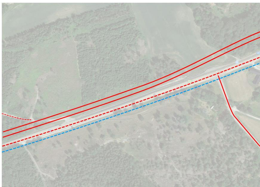
Figur 30. Bjärbylund. E22 visas med röd heldragen linje liksom sidoväg söder om E22. Streckad linje symboliserar parallell lokalväg (röd streckad) med gång- och cykelväg (blå streckad).
