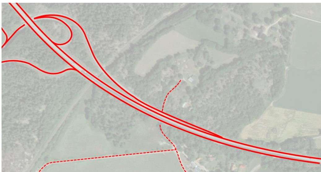
Figur 18. Föreslagen parallellavfart i trafikplats Ronneby Öst. Streckade linjer är sidovägar.
