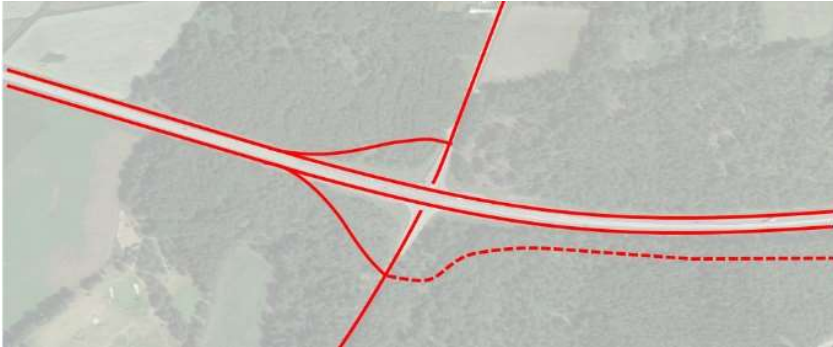
Figur 18. Föreslagen utformning av trafikplats Björketorp, principskiss. E22 och ramper visas med röd heldragen linje, lokalväg är röd streckad linje.
