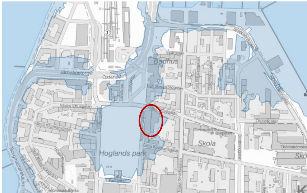
Bild 28. Kartan visar påverkan på den norra delen av Trossö med en översvämning på 2 meter. Planområdet markeras i rött.
