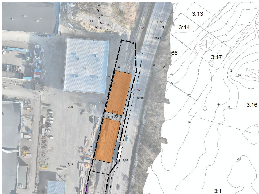
Bild 12. Karta som visar befintlig och planerad ny bebyggelse i norra delen enligt planförslaget. Föreslagna byggnader för störningsfri el redovisas med orange färg. Tunn streckad linje redovisar justerat läge av gång- och cykelvägen.
