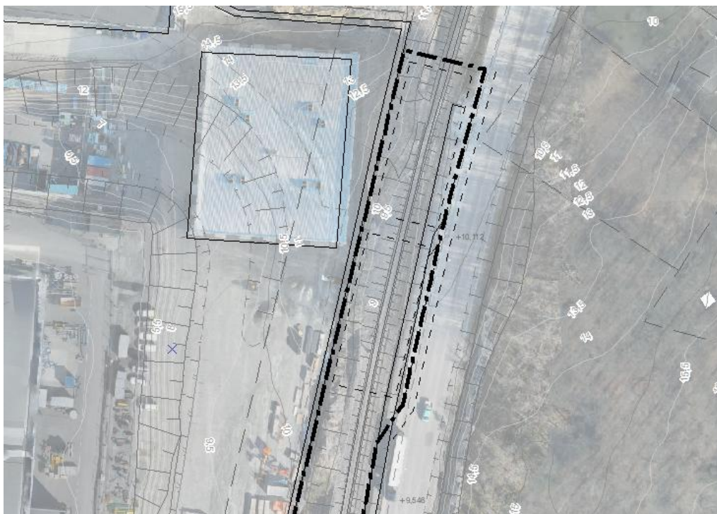
Bild 22. Föreslagna nya byggnader i norra delen innebär att filen för lastbilar behöver kortas ner och gång- och cykelvägen flyttas ut mot körbanan. Heldragen illustrationslinje redovisar dagens cykelväg och streckad linje redovisar ett justerat läge av gång- och cykelvägen efter byggnaderna är på plats.
