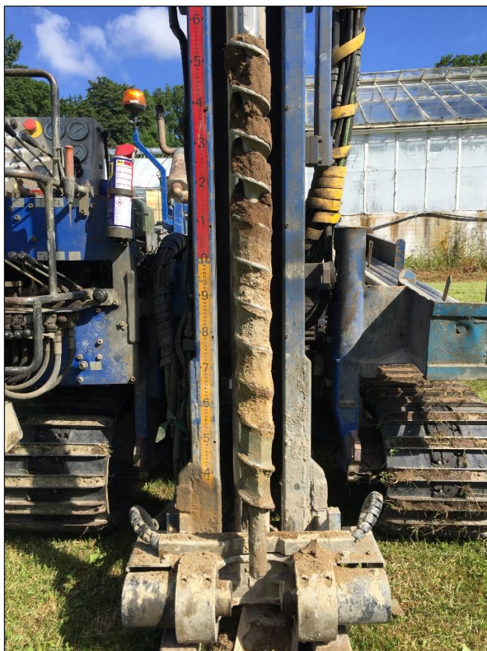
Figur 4. Skrubborning av GV1. Skruven visar den översta metern av jordprofilen. Överst syns den mulljorden och längst ner syns den gråa siltiga leran.
