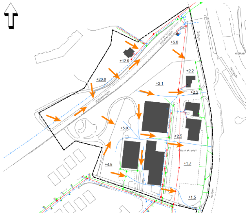
Bild 46. Befintliga rinnvägar i blått, flödespilar i orange och befintliga höjder. (Norconsult).
