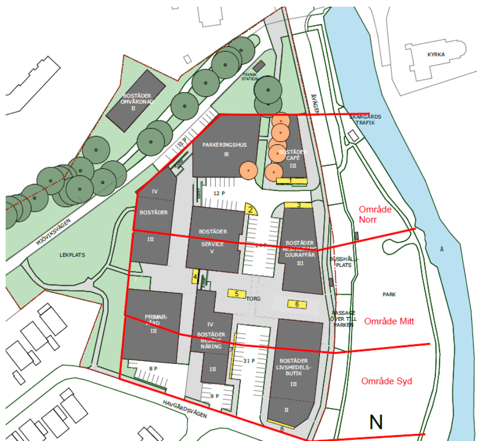
Bild 49. Föreslagen dagvattenhantering. Gult anger föreslagna regnbäckar och orange flödesriktningen (Norconsult, 2024).
