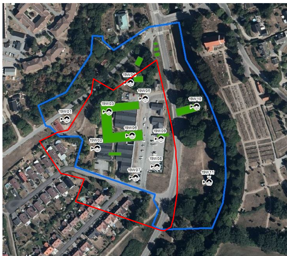
Bild 63. Ungefärlig placering av provpunkter och grundvattenrör. Blå linje visar område för undersökningen och röd linje markerar planområdet. Källa kartmaterial: Lantmäteriet
