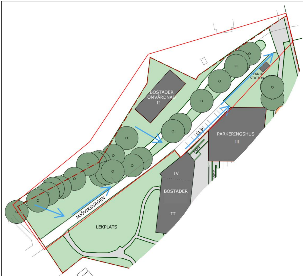
Figur 15. Öppet dagvattensystem för norra delen av planområdet runt Mjöviksvägen (inringat med rött). Gröna ytor fungerar som översilningsytor för dagvatten vilket leder till ett trögt och hållbart dagvattensystem.
