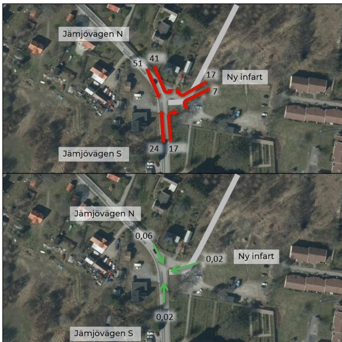
Figur 14. Trafikflöden och belastningsgrader i maxtimmen med trafiken för år 2050 efter byggnation av de nya bostäderna.
