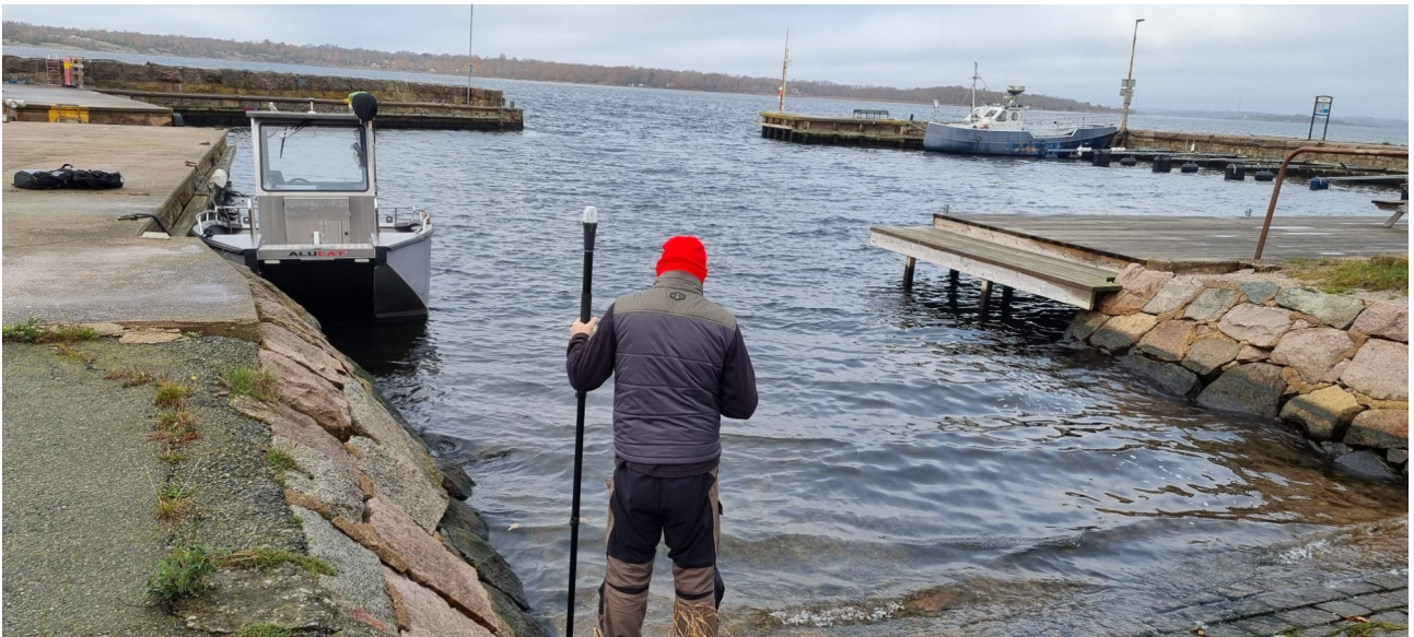
Bild 11. Inmätning av vattenyta med Emlid RTK. Foto: Johanna Långström
