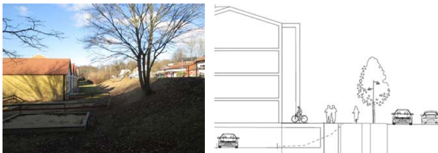
Bild. 16. Skolbyggnaderna i den norra delen av Skolan 2 sedda från söder. Byggnaderna ligger långt in från Augerumsvägen på en nivå på ca 3 meter under vägens höjd. Nivåskillnaden föreslås nyttjas för ett parkeringsdäck enligt sektionen
