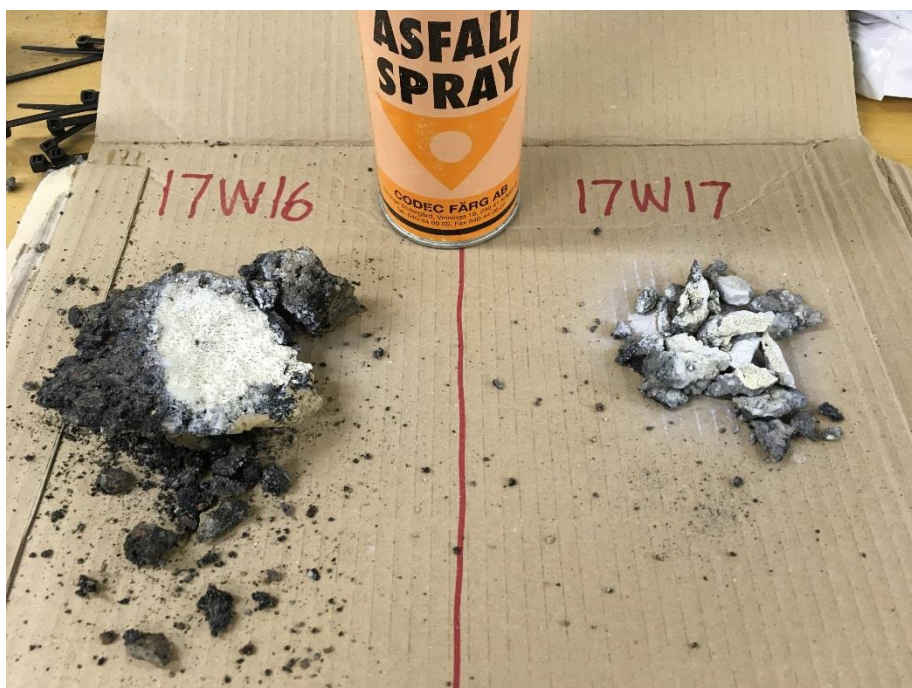
Figur 3. Ytbeläggning i form av asfalt förekom endast i två undersökningspunkter. Ingen av dessa indikerade hög halt PAH vid spraytest.
