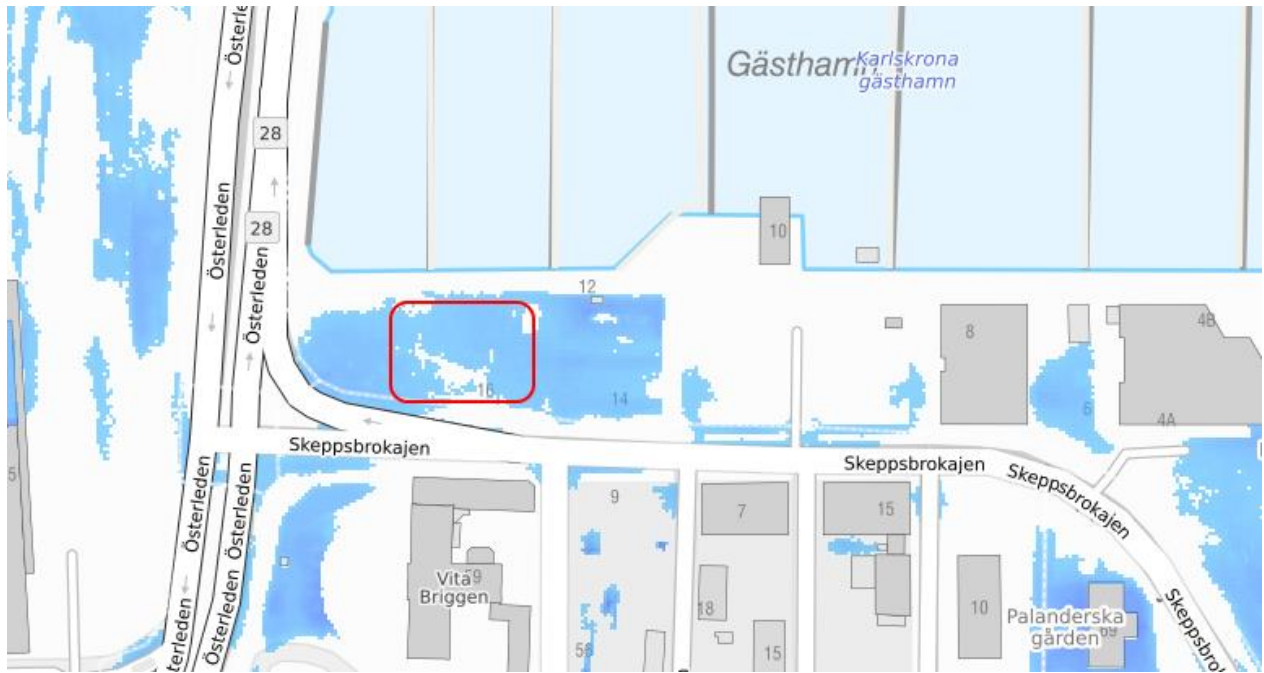
Figur 4. Lågpunkter och stående vatten vid ett 100-årsregn med klimatfaktor. Vattendjupet uppgår till max 0,3 m. Rött område visar ungefärlig utbredning av fastighet Skeppbron 5.
