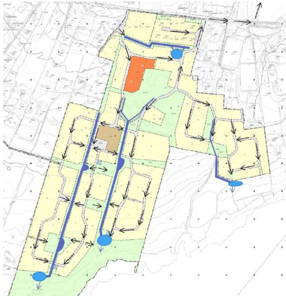
Bild 28. Principskiss över föreslaget dagvattensystem. Blå linjer symboliserar diken, som på några platser breddar ut till översvämningssytor. Ljusare blå cirklar är dammar. Pilarna visar föreslagen flödesriktning. (Norconsult 2022)
