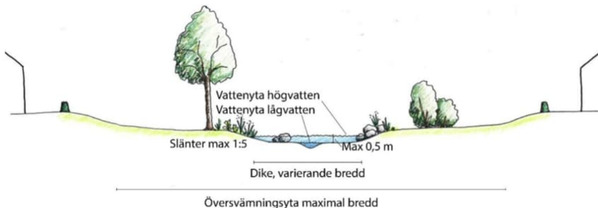
Figur 16: Sektion större dike (Illustration: Norconsult).
