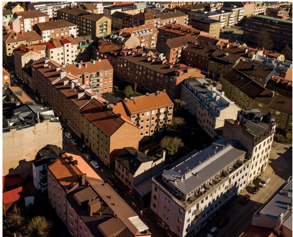
Bild 11. Taklandskap inom kvarteret Rosen. Bilden visar det varierade taklandskapet med sadeltak, indragen översta våning samt brutet tak.
