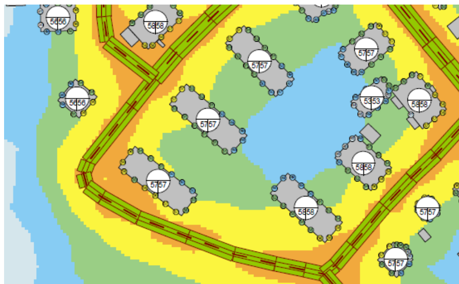
Bild 38. Framtid 2030. Utsnitt ur trafikbullerberäkningen över Karlskrona stadsbygd från 2014. Blått motsvarar upp till 45 dB(A) ekvivalent ljudnivå, grönt 50 dB(A) ekvivalent ljudnivå, gult upp till 55 dB(A) ekvivalent ljudnivå, orange 60 dB(A) ekvivalent ljudnivå och rött 65 dB(A) ekvivalent ljudnivå.
