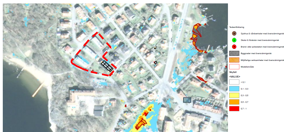
Bild 39. Utsnitt ur Karlskrona kommuns Klimatanpassningsplan med analysresultat av skyfallskartering utförd av WSP 2017 över 100-årsregn, 30 minuters varaktighet.
