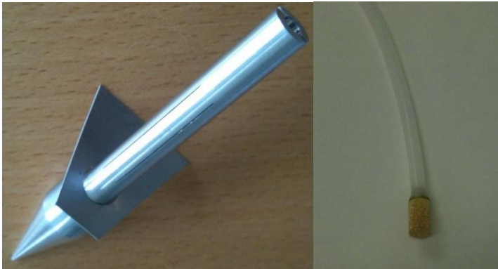
Figur 3 Till vänster: Spets av aluminium (diameter 16 mm, s.k. KVA shield point) utrustad med ett antal 0,2 mm slitsar. Till höger: sintrad spets.
