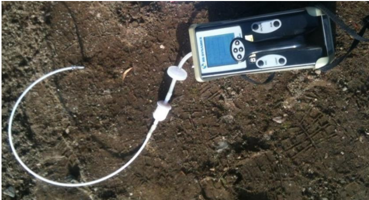
Figur 4. Multigasmätare (av typ Ecoprobe 5 från RS Dynamics)
