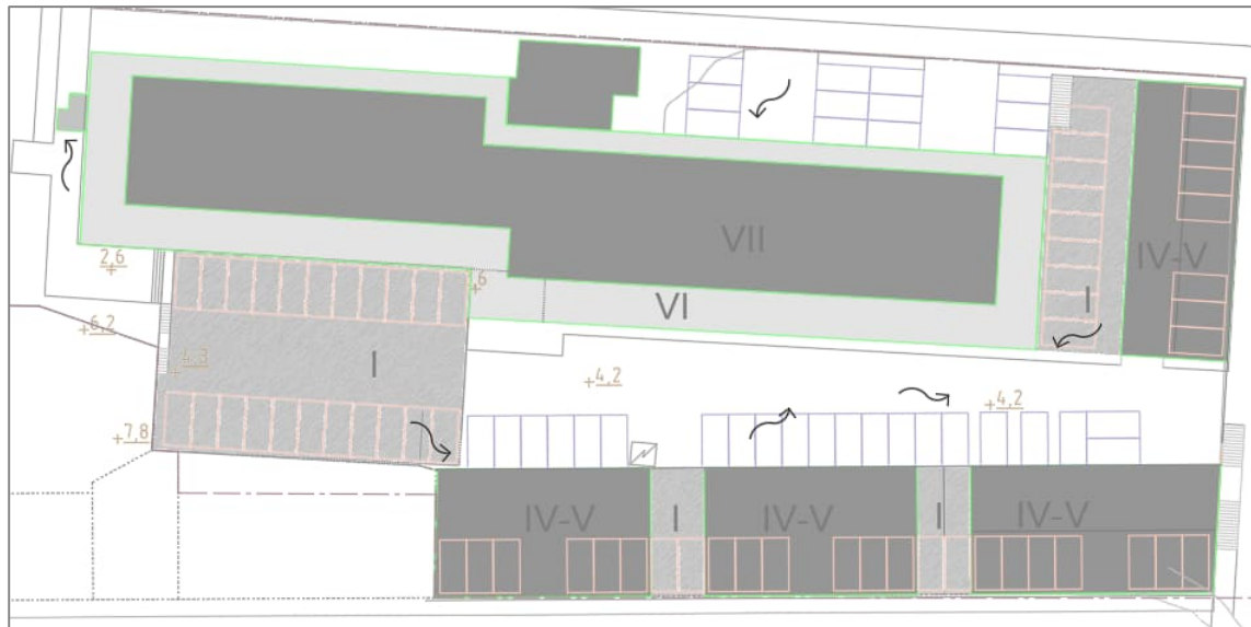
Figur 19. Föreslagen avrinning från upphöjda gårdar och hårdgjorda ytor för planområdet, flödespilar i svart.
