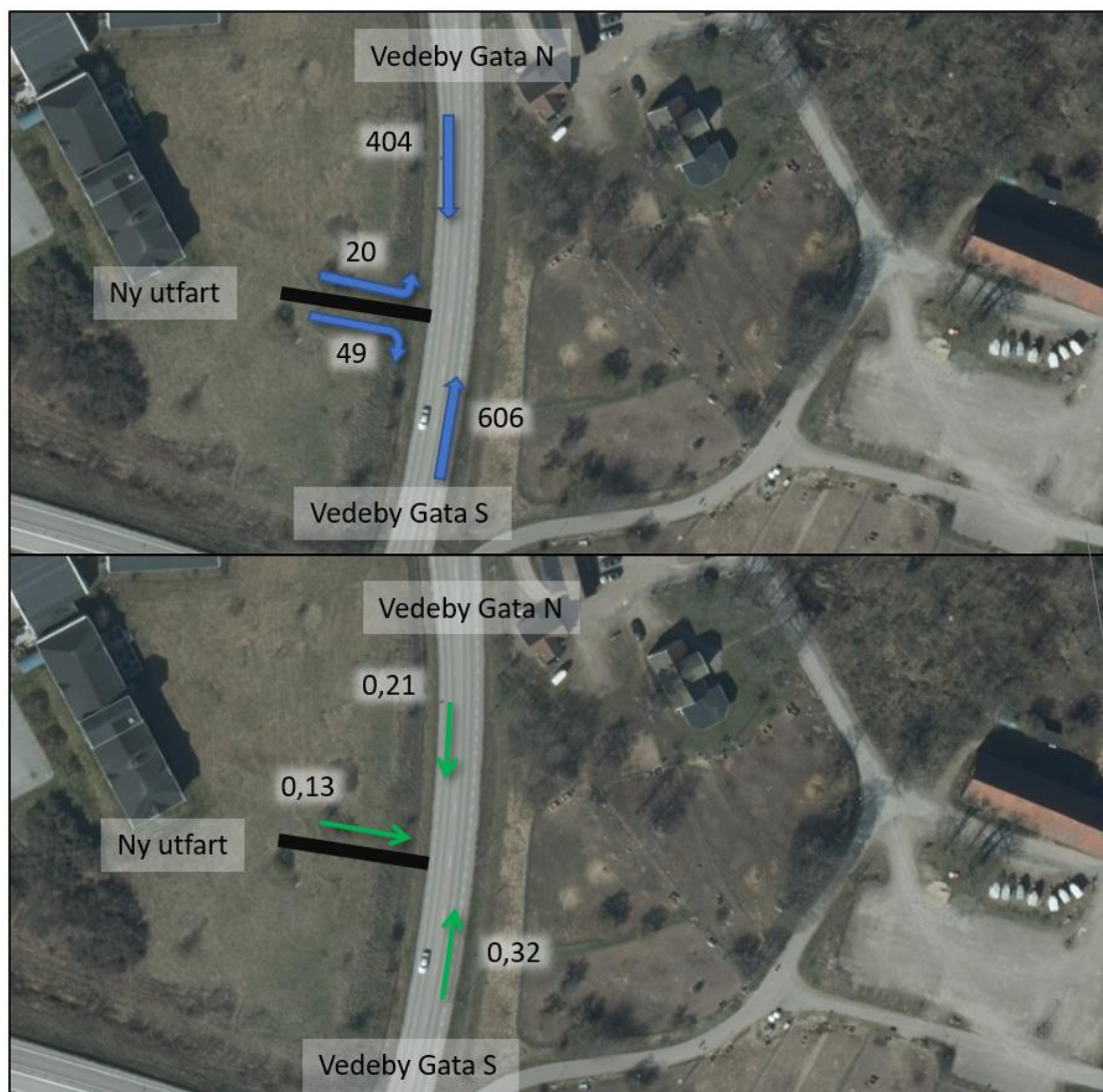
Figur 18. Trafikflöden och belastningsgrader i maxtimmen med trafiken för år 2043 i korsningen Vedeby gata / ny utfart från planområdet.
