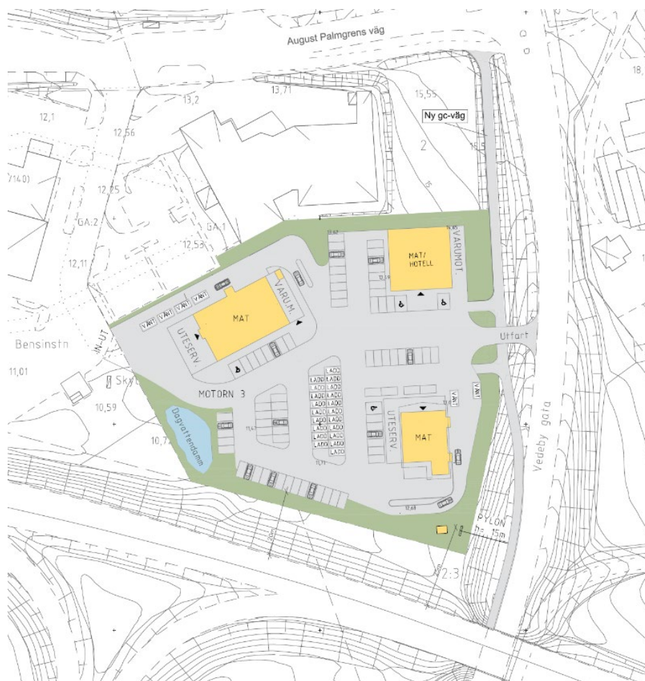
Bild 6. Illustration över planområdet som visar utvecklingsplaner med ny utfart och ny gång- och cykelväg.
