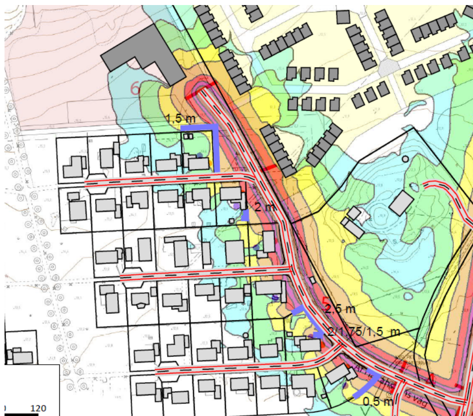
Bild 54. Föreslagna åtgärder för att klara riktvärdena på uteplats på de fastigheter som berörs av den ökade trafiken med anledning av planerad ny förskola/skola.
