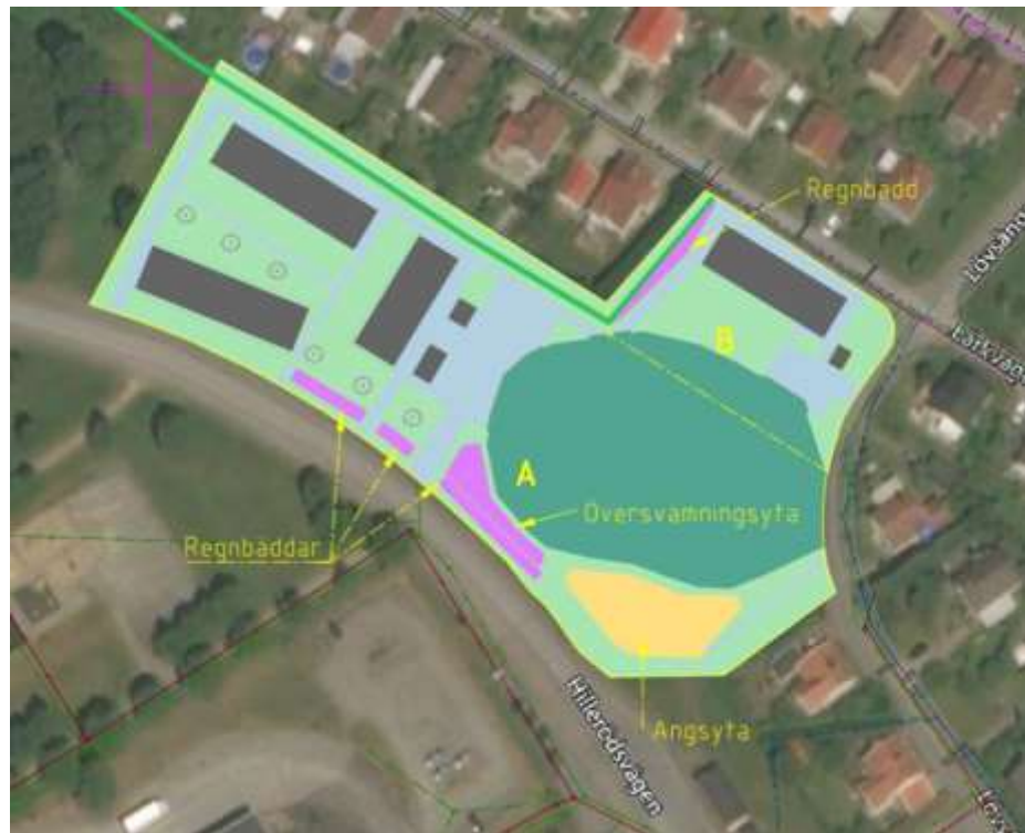
Bild 15: Föreslagen dagvattenlösning enligt framtagen dagvattenutredning (Norconsult 2022-05-11)
