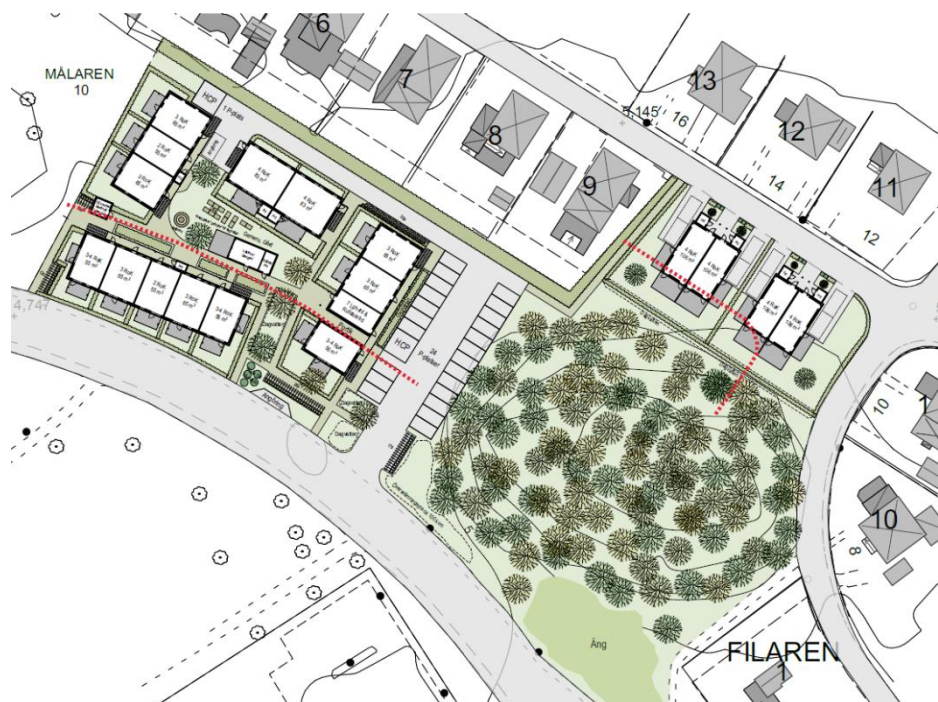
Bild 24. Redovisning av avstånd där riktvärde för uteplats 50 dBA ekvivalent ljudnivå samt 70 dBA maximal ljudnivå vid uteplats uppfylls utan avskärmande byggnader eller andra bullerdämpande åtgärder. Riktvärdet 60 dBA ekvivalent ljudnivå vid en bostadsbyggnads fasad uppfylls inom hela planområdet. Beräkningen grundar sig på uppskattad trafikmängd 2040.
