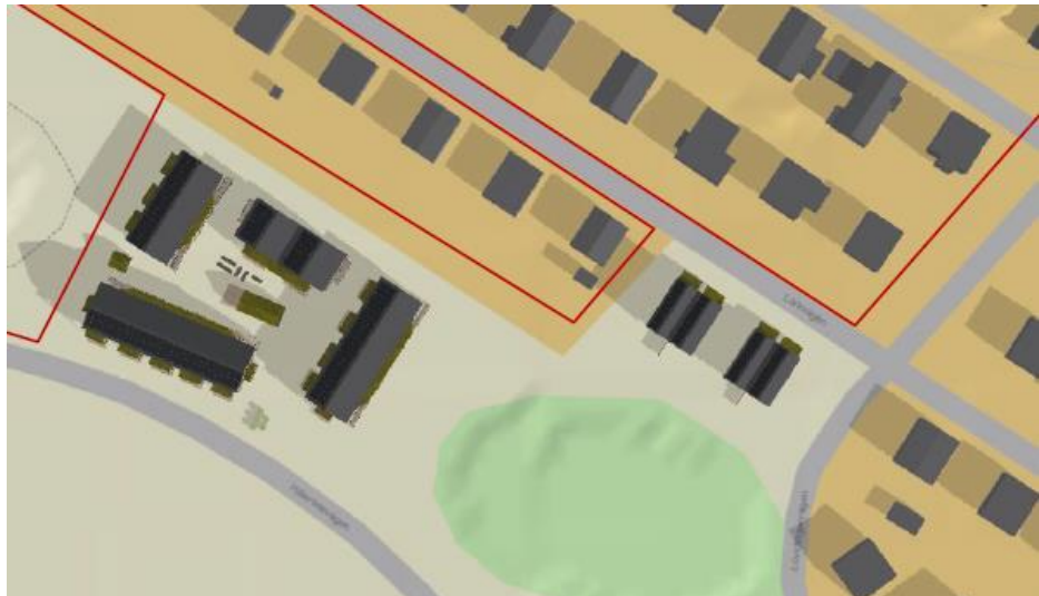
Bild 20. Bild visar att ett bostadshus kan bli påverkat av skugga under vårdagjämningen kl. 9:00. Skuggningen vara dock endast till ca 9:30. Röd linje visar ungefärlig gräns för fastigheternas yttre gränser.
