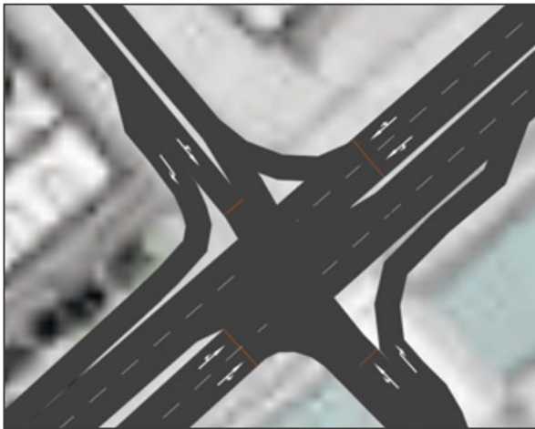
Figur 3-5 Körfältsindelning i den tidigare testade lösningen med två plankorsningar på infartsleden.
