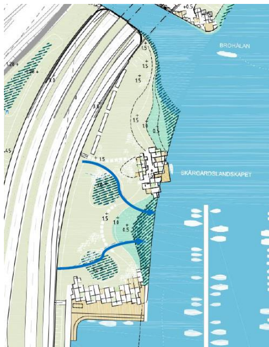
Bild 90. Planområdets östra delar och tänkt avrinning vid skyfall markerat med blå pilar.
