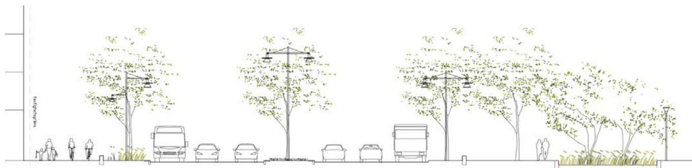
Sektion över Stadsboulevarden. Ett system av olika stolphöjder och armar, ger nödvändig flexibilitet och kombinationsmöjligheter, samtidigt som belysningstypen har en röd tråd.
