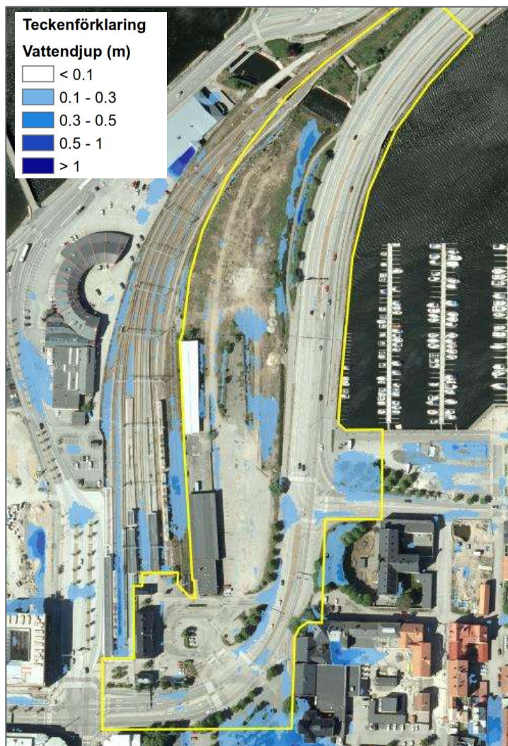
Figur 14. Skyfallskartering över planområdet med lågpunkter markerade i blått. Vattendjup från 0,1 m till över 1 m markerade i blå färgskala. Planområdesgräns markerat med gult.
