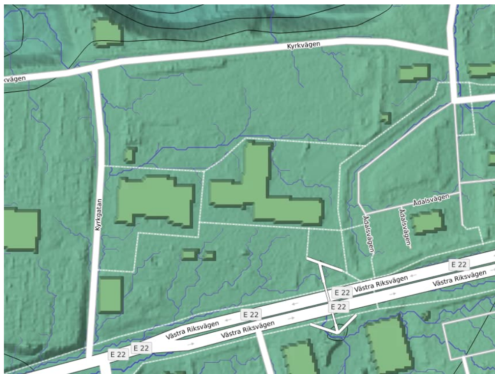
Figur 7. Utklipp från avrinningsanalys i Scalgo-Live. Rinnvägar vid skyfall i befintlig situation visas som lila streck.
