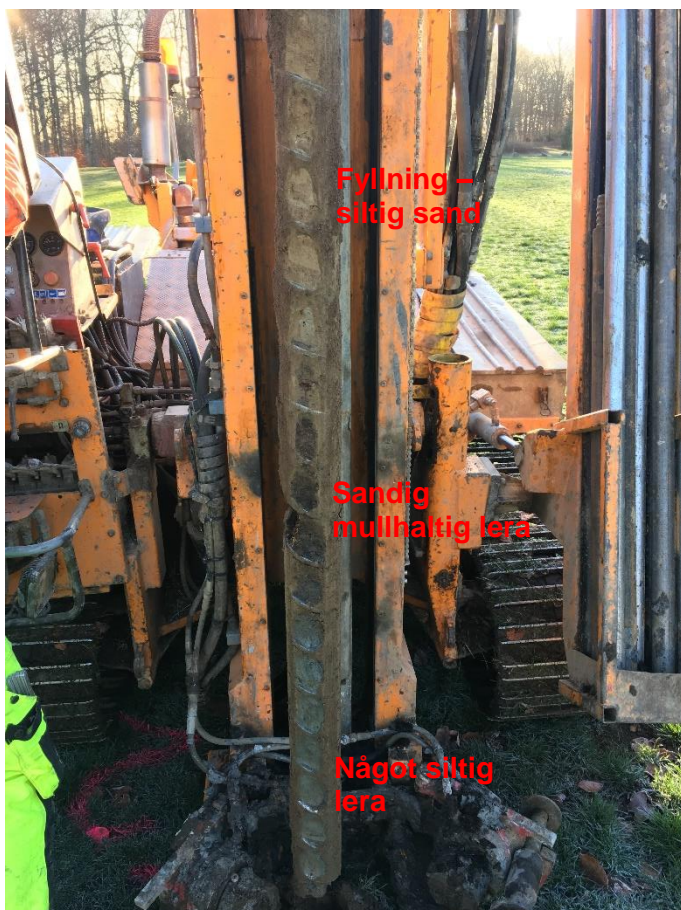
Figur 5. Provpunkt SW1802 i nivån 0–2 meter under markytan. Fyllnadsmassor påträffas i nivån 0–1 meter under markytan och i massorna påträffas PAH-M och PAH-H överskridande Naturvårdsverkets generella riktvärde för känslig mark.
