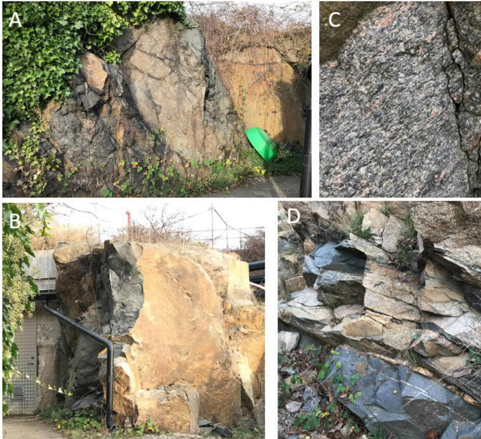
Figur 13 Bild visar vänster sida om dörr till nödutgång, Bild B visar höger sida. Bild C närbild av Tvinggraniten och i nedre delen av bild D syns ett mörkgrått tonalitiskt band.
