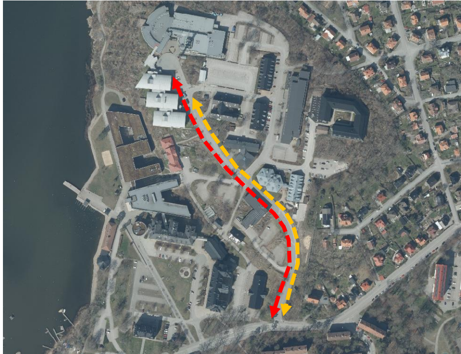
Bild 25. Avsikten är tillskapa en gång- och cykelbana, röd streckad linje, längs med Minervavägens västra sida och en trottoar, gul streckad linje, längs den östra sidan.
