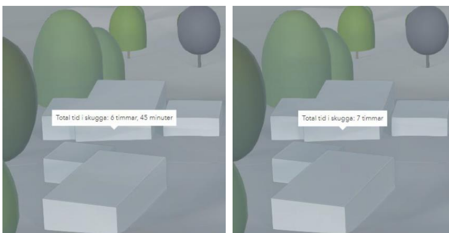
Bild 18-19. Solstudie som visar bostadsfasads totala tid i skugga mellan kl. 8:00 – 16:00 under vintersolstånd. T.v. nuläge och t.h. vid full utbyggnad inom aktuellt planområde. Förändringen innebär att fasaden är i skugga ca. 15 minuter mer.
