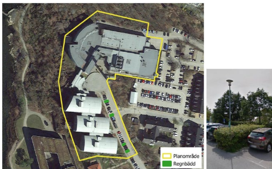
Bild 34. Möjlig placering av föreslagna regnbäddar som ska fördröja och rena dagvattnet från planområdet. Bild t.h. visar ytornas befintliga utformning. Figur 5 ur kompletterande dagvattenutredning (Norconsult, 2023).
