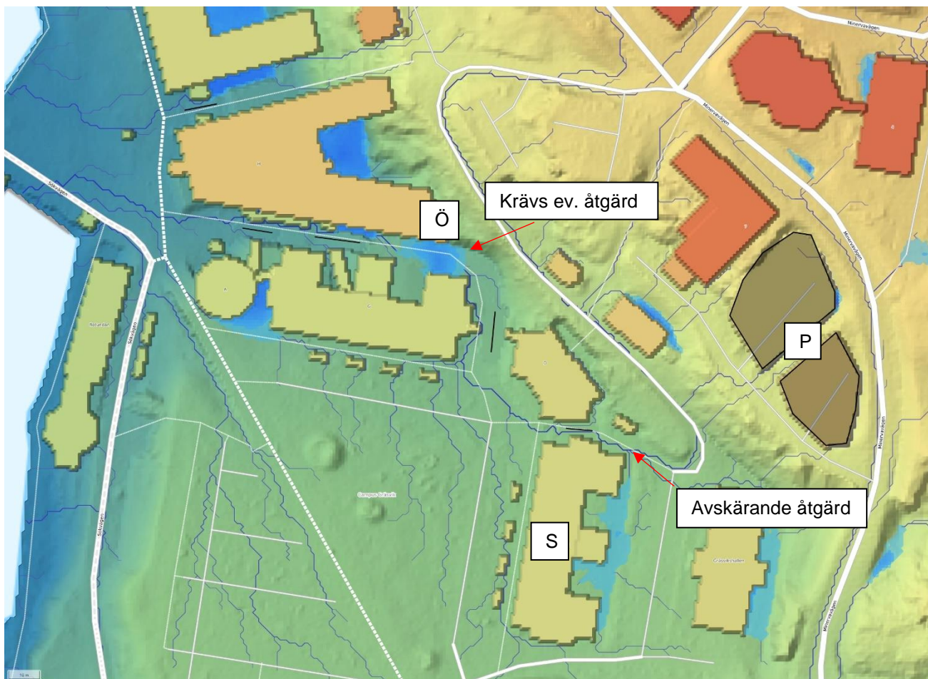
Figur 18: Analys av avrinningsvägar och områden där vatten blir ståendes vid ett framtida 100-årsregn (55 mm). Skolbyggnad markerad med S och befintliga lågpunkter som nu bebyggts av ett P-hus markerat med P. Kritisk plats där situation riskerar att försämras är markerad med Ö.
