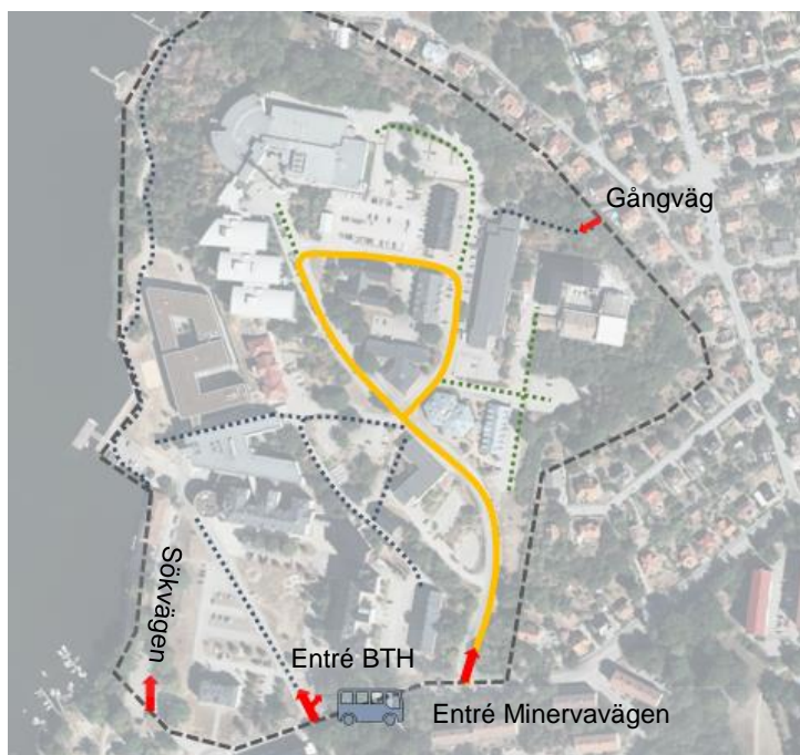
Figur 3 Översiktsskarta över områdets anslutningar, väghierarki och hållplatslägen. Den gula sträckningen visar områdets huvudgata, Minervavägen, de grönstreckade är lokalgator och de övrigt svartstreckade är gång- och cykelstråk. De röda pilarna visualiserar områdets in- och utfarter.
