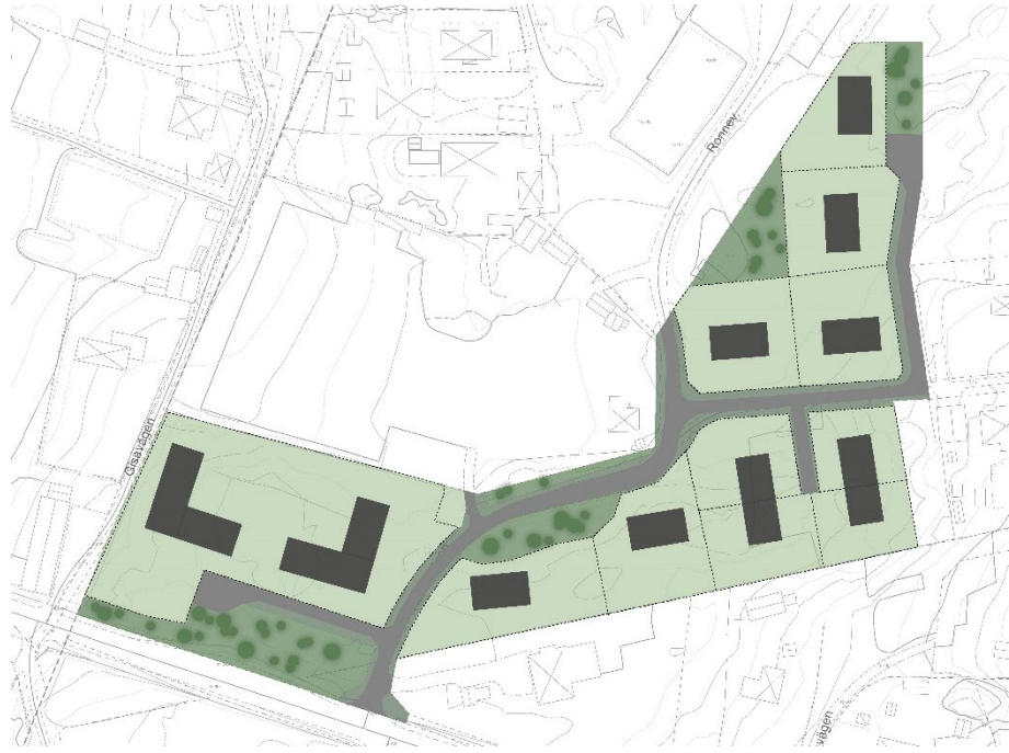
Bild 7. Illustrationsplan som redovisar hur bebyggelse skulle kunna vara placerad om området bebyggdes med viss villabebyggelse men även parhus i sydost och flerbostadshus i den västra delen.
