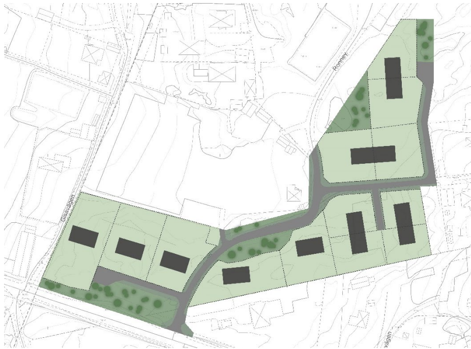
Bild 6. Illustrationsplan som redovisar hur bebyggelse skulle kunna vara placerad om området bebyggdes med villor i den västra delen och parhus i den östra delen.
