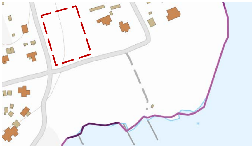
Bild 8 Strandens eroderbarhet visas med lila linjer där en mörkare lila färg indikerar en större eroderbarhet.
