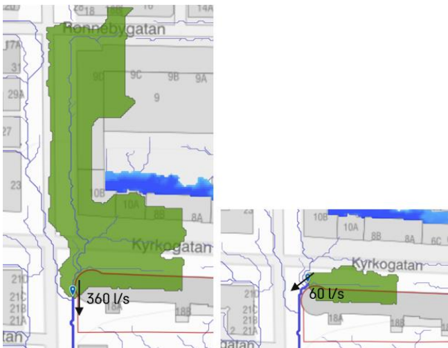
Figur 20. Beräknade flöden i nedströms punkt inom olika delavrinningsområden (gröna polygon) för nordvästra sidan av byggnaden.
