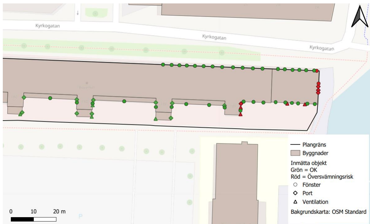
Figur 11. Inmätta objekt längs med byggnadens fasad. Grön symbol innebär att det inte finns någon risk för översvämning med hänsyn till dimensionerande säkerhetsnivå för platsen år 2130, och röd symbol visar på en risk för översvämning. Se Figur 12 och Figur 13 för bilder vid de olika objekten med risk för översvämning.
