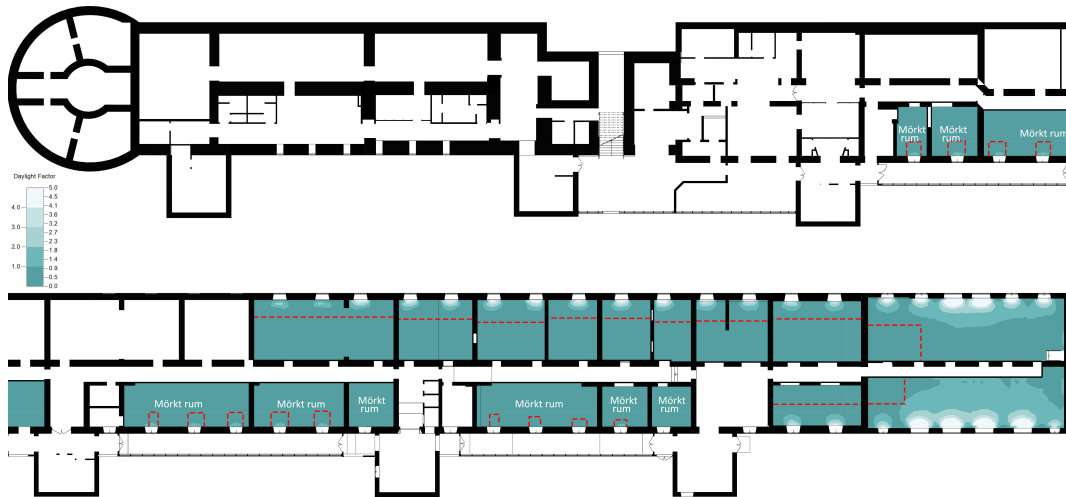
Figur 1: Beräkning av dagsljusfaktorn på plan 0. För de rum som är märkta som mörka rum beror bristen på tillräckligt dagsljus på att deras fönster inte har en direkt anslutning till utomhusmiljön. För att förbättra dagsljusinsläppet i dessa utrymnen behöver vi ta bort den passagen framför deras fönster.
