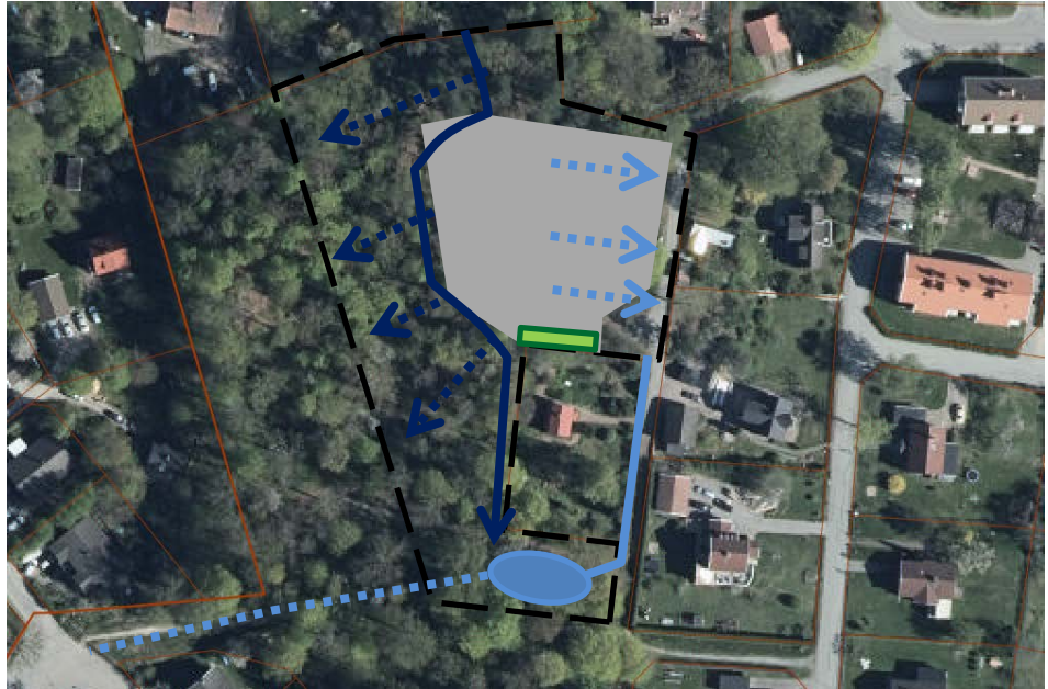
Bild 19. Schematisk skiss över föreslagen dagvattenlösning
