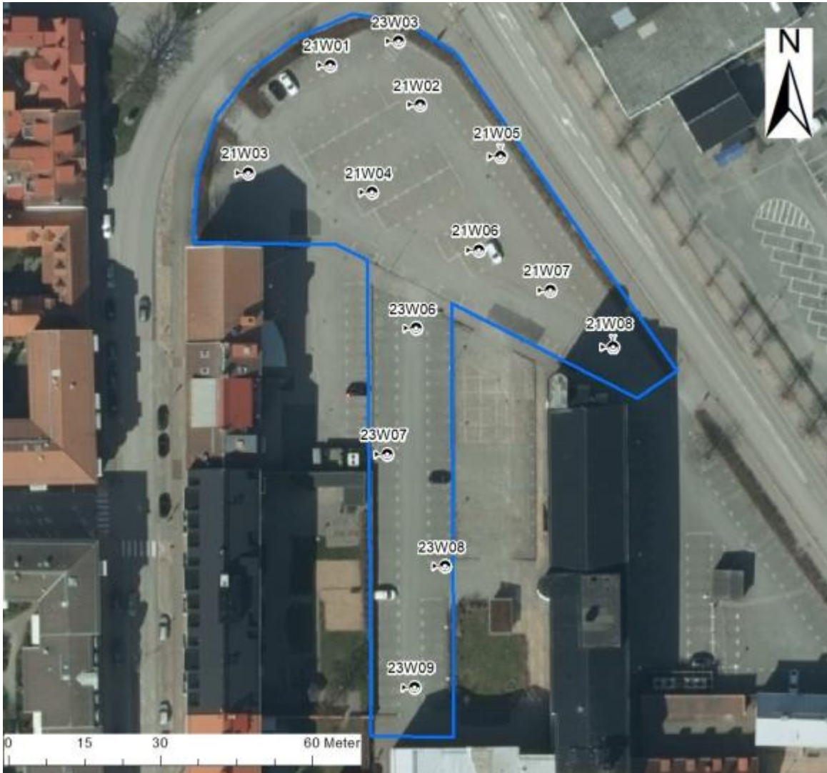
Figur 4 Flygfotot visar placering av provpunkterna som utfördes vid undersökning 2021 och 2023. Källa kartmaterial: Lantmäteriet.
