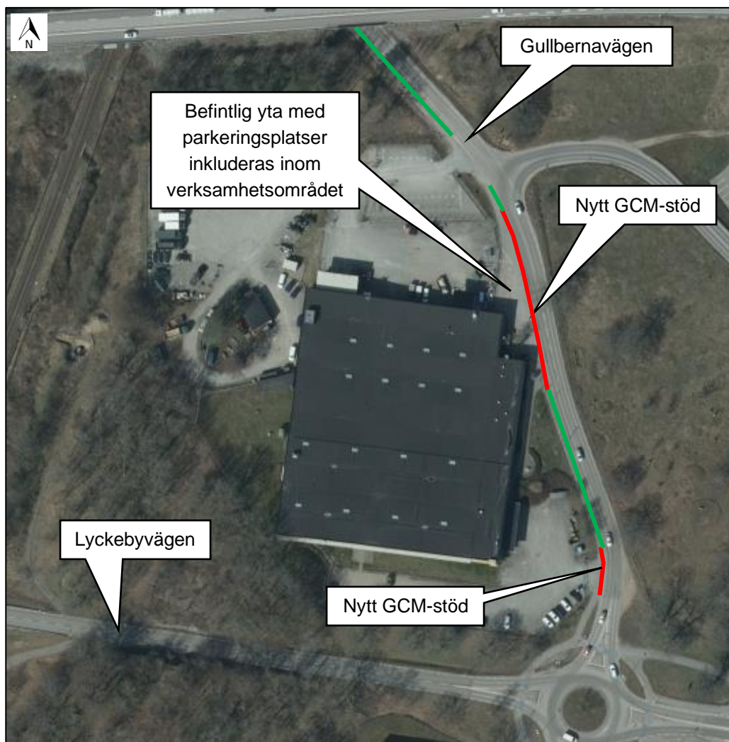
Figur 14. På sträckor med röd linje föreslås huvuddelen av den befintliga målningen av cykelfält ersättas med ett avskiljande GCM-stöd mellan gång- och cykelvägen och körbanan. På sträckor med grön linje föreslås befintlig separering behållas.
