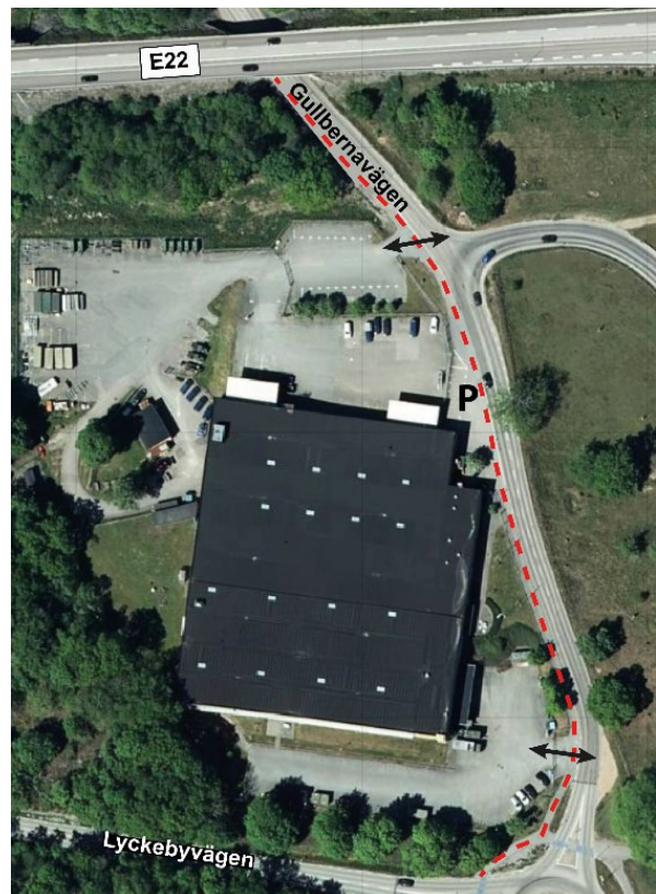
Bild 12. Pilarna visar befintliga in- och utfarter till fastigheten Telefonen 1 och parkering (P) intill gång- och cykelvägen. E22 syns i norr. Gång- och cykelvägen är rödmarkerad.
