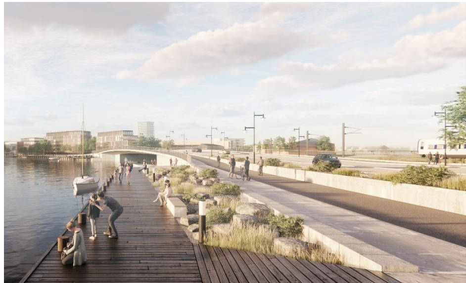
Bild 89. Exempel på planteringskärn/ avåkningsskydd i betong utmed Österleden. Kustskyddet består av betongelement som placeras ca en meter ifrån varandra för att möjliggöra för plantering och vegetation.
