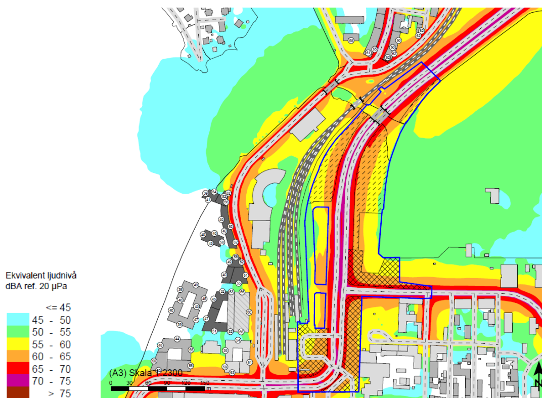
Bild 80. Utdrag ur trafikbullerutredningen som visar att ekvivalent ljudnivå vid fasad för befintlig bostadsbebyggelse inom Pottholmen etapp 1 år 2040 uppgår till som högst 62 dB(A) vid fasader mot vägen Järnvägstorget. För planerad bostadsbebyggelse blir den ekvivalenta ljudnivån som högst 62 dB(A) vid fasader mot Blekingegatan.
