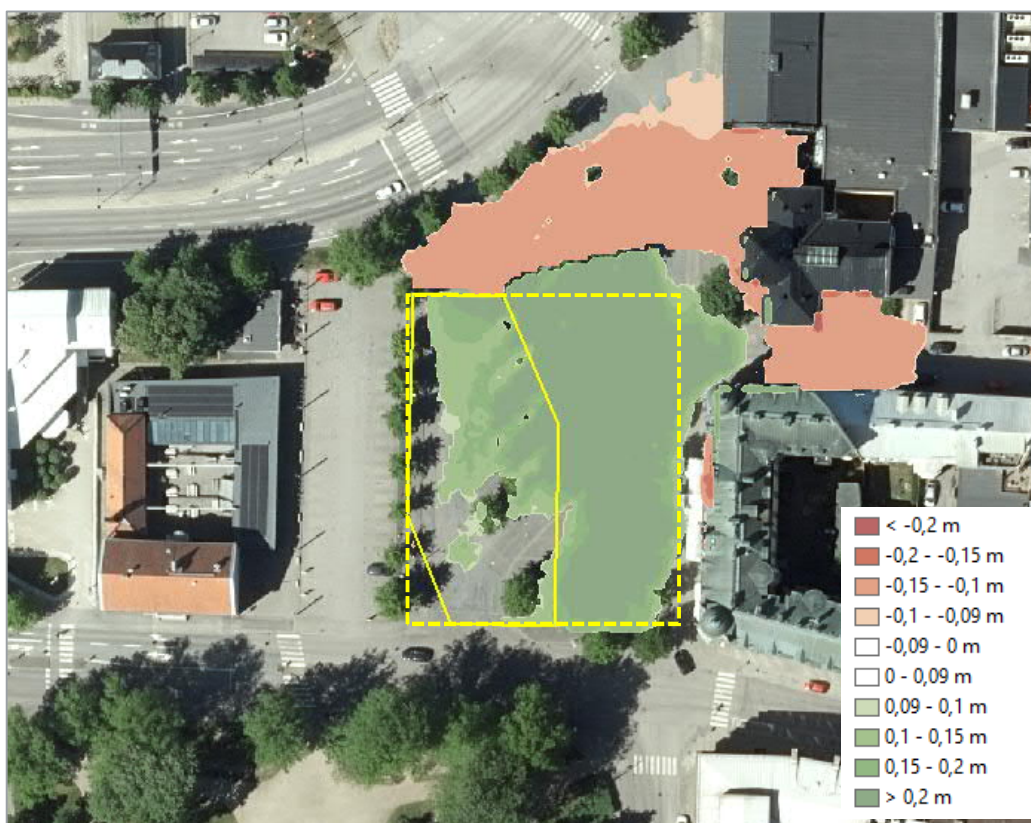
Figur 13. Differens i maximalt vattendjup mellan föreslagen exploatering och befintliga förhållanden. © Lantmäteriet, Geodatasamverkan.
