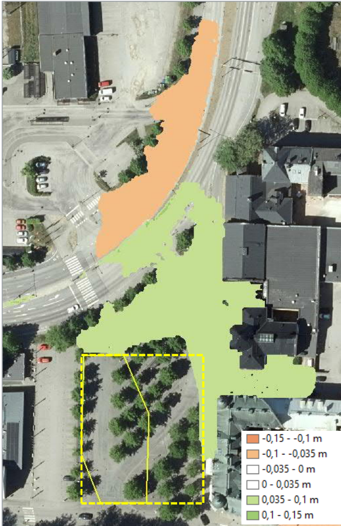
Figur 15. Differens i maximalt vattendjup mellan föreslagen exploatering och befintliga förhållanden. © Lantmäteriet, Geodatasamverkan.
