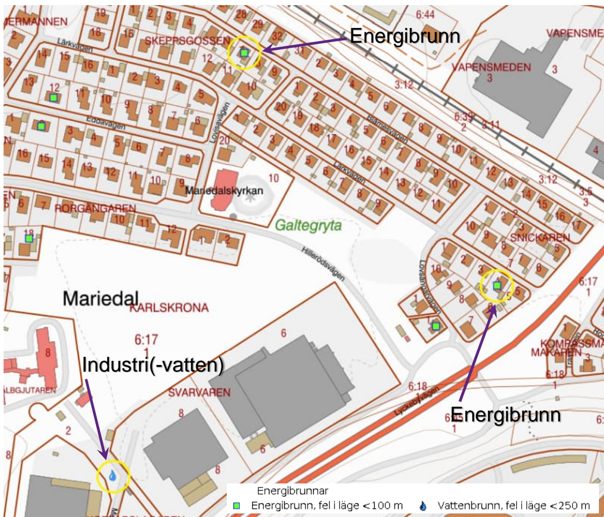
Figur 8. Brunnar: Skeppsgossen 7 Energibrunn (värme och/eller kyla) Grundvattennivå 7 m under markytan, borrdatum 2011. Svetsaren 4 Energibrunn (värme och/eller kyla) Grundvattennivå 2 m under markytan, borrdatum 199701. Mejeristen 1 Industri(-vatten) Grundvattennivå 2,6 m under markytan, borrdatum 19980604 (SGU, 2022).
