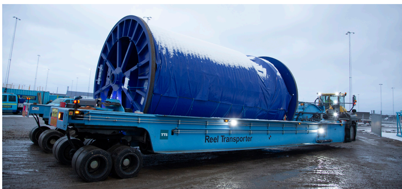
Transport av kabeltrumma med TT100 och 52 tons fordon (foto: NKT)
