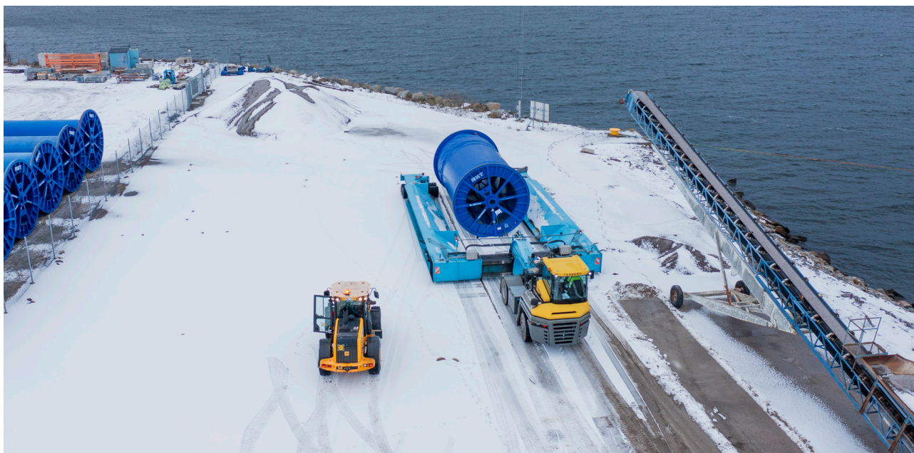
Transport av kabeltrumma med TT100 och 52 tons fordon (foto: NKT)
